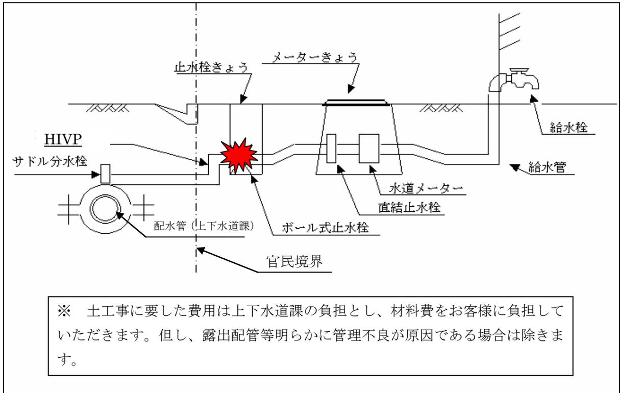
事例 D サドルの老朽化に伴う錆による水圧不足の場合
