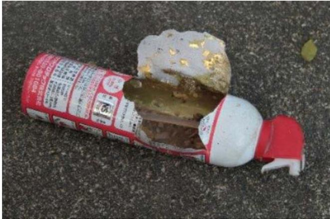
図2 内部腐食の進行により破裂した
